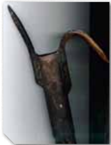
Eiserne Feuerhaken dienten zum Einreißen von Bauteilen Les crocs à feu servaient au démolissage de toits et de murs.
