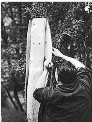
Abschälen der Rinde mit Hilfe des Lohschleißers Ecorçage à l'aide du «Lohschleißer»
